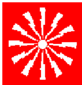
PULSANTE DI ALLARME ANTINCENDIO
